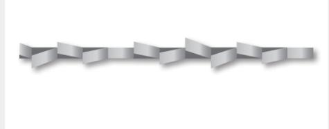
Unterschiedliche Schränkweiten ermöglichen optimale Aufteilung des Schnittkanals. Ergebnis ist die Erhöhung von Schnittleistung und Standzeit.
